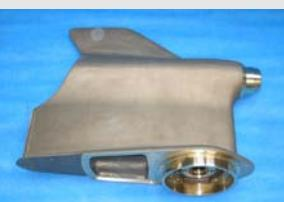
Für unseren Kunden Volvo Penta haben wir die bewährte Seewasser - beständige Legierung G-CuAl10Ni weiterentwickelt, um umweltschonende öldichte Gussteile mit anspruchsvoller Innenkontur herstellen zu können. Es handelt sich um Bauteile für den innovativen IPS-Drive von Volvo Penta, die komplett im Meerwasser hängen. Die beiden Gussteile wiegen 61 kg bzw. 63 kg und werden durch eine spezielle Wärmebehandlung gegen korrosive Angriffe passiviert.
